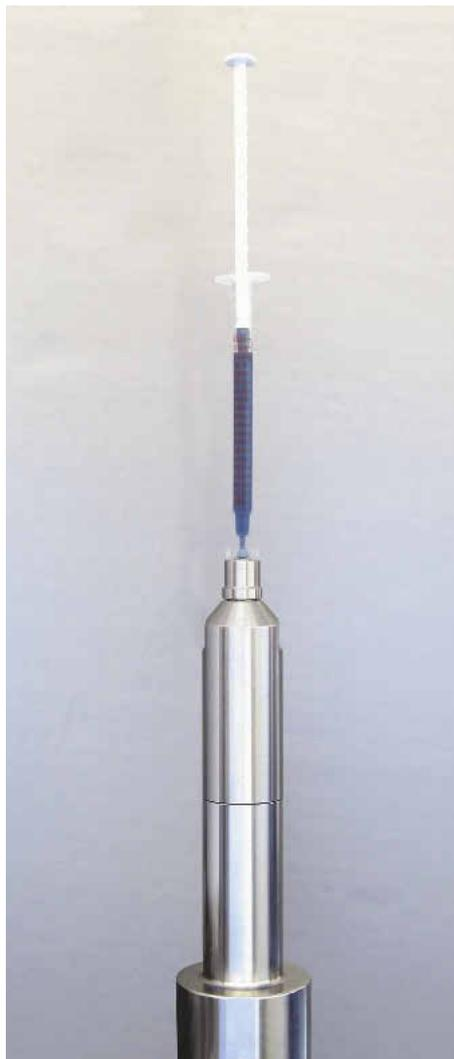
*Die Spritze wird am Pumpenausgang des Pharma Dispensers über einen Adapter aufgesteckt. Der Füllvorgang wird vom Bediener gestartet.*
