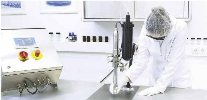
**Halbautomatische und luftblasenfreie Abfüllung mit dem Viscotec Pharma Dispenser. Die Dosiertoleranzen betragen unter 0,5%.**
